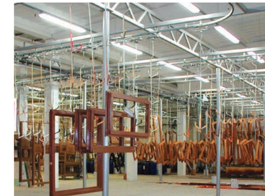
Holzfenster: klimatisierter Trockenofen
