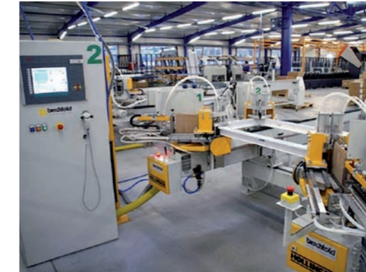
Kunststofffenster: verschweißen der Rahmen mit einer Genauigkeit von 0,1 mm
