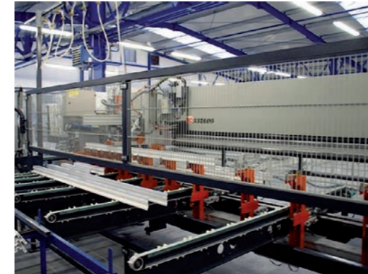
Kunststofffenster: automatisierte Montage und Vorbereitung von Beschlagsfräsungen
