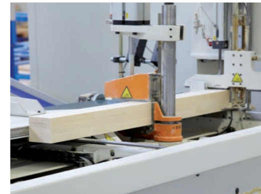
Holzfenster: fräsen der Fensterkanteln
